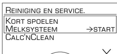
Het melksysteem **10** kan automatisch worden voorgereinigd.
