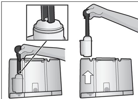
**Informacja:** Płukanie filtra **29** włącza jednocześnie ustawienie dla wskazania wymiany filtra.
