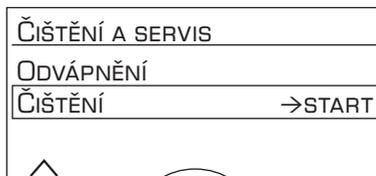
Během jednotlivých čisticích postupů bliká tlačítko **8 start**. Číslice vpravo nahoře zobrazují jednotlivé fáze programu.
