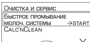
Насадку для приготовления молочной пены **10** можно предварительно очистить автоматически.
