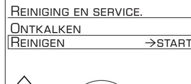
Gedurende de afzonderlijke reinigingsstappen, knippert toets **8 start**. De getallen rechtsboven aan geven aan hoe ver het proces is.
