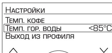
С помощью кнопок выбора **4** ^ и **v** можно выбирать различные возможности настройки.
