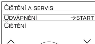
Během jednotlivých odvápněvacích postupů bliká tlačítko **8 start**. Číslice vpravo nahoře zobrazují jednotlivé fáze programu.
